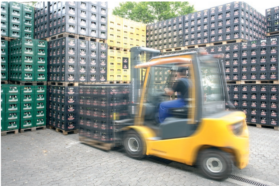
Bild 1: Zur Überprüfung der auf dem Schwingungssimulator mit den verschiedenen Fahrersitzmodellen erzielten Ergebnisse wurden Feldmessungen durchgeführt
